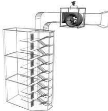
Şekil 2.5 Kaçış merdiveninin havalandırılması
